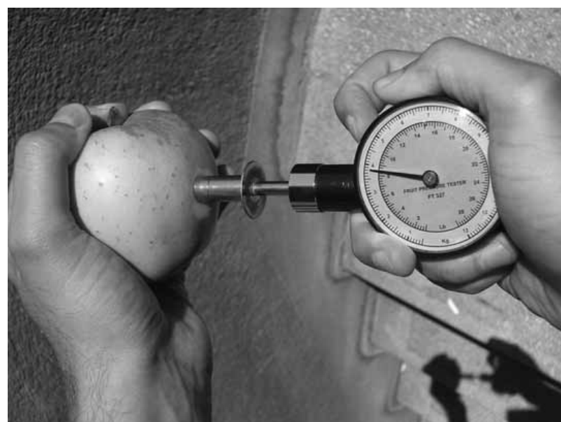
Određivanje čvrstine parenhima ploda pomoću penetrometra (N. Magazin)
