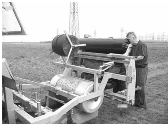
Slika 19. Mašina za formiranje bankova, postavljanje folije i traka za navodnjavanje (N. Magazin)
