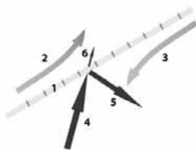
Sl. 5 Prenos toplote i gubici u plasteniku bez dodatnog grejanja
