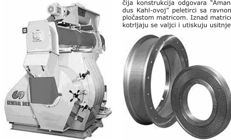
(Sl. 3. Presa za peletiranje „General Dies“ i prstenaste matrice)
