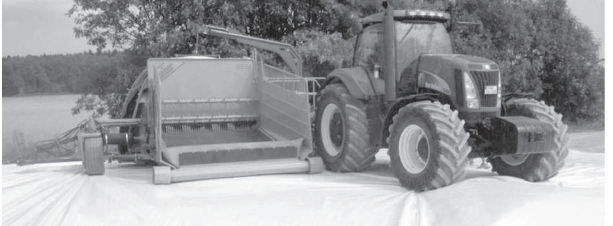
Mašina za punjenje stočne hrane u vreće (silo kobasicu)
