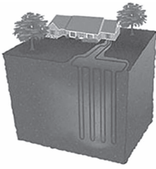
Slika 4. Šematski prikaz toplotne pumpe sa dva ili četiri bunara
