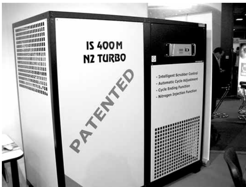
Slika 26. Generator azota marke „Isolcell“
